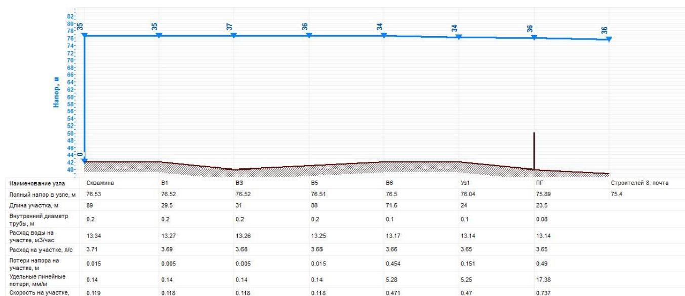
Рисунок 1.5 – Пьезометрический график от скважины до удаленного потребителя п. ст. Громово.
