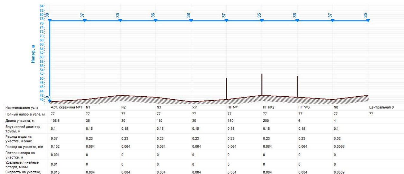
Рисунок 1.4 – Пьезометрический график от скважины до удаленного потребителя п. Громово.
