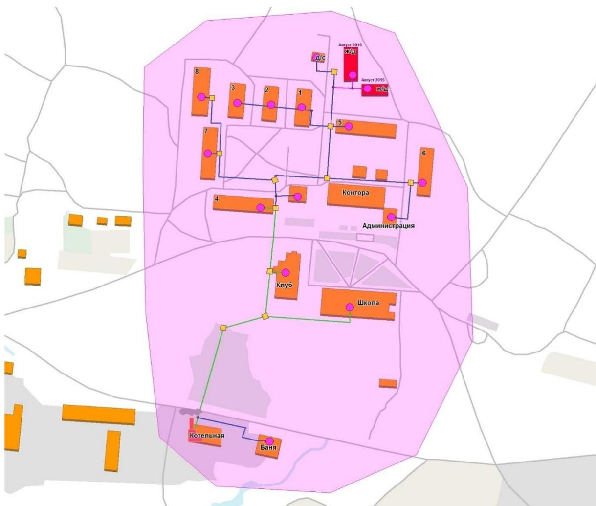
Рисунок 1.4.1.2. – Зона действия котельной п. ст. Громово
